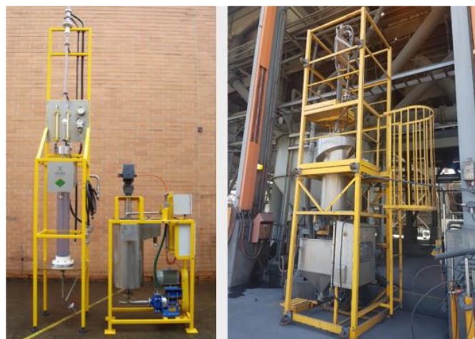
Figura 5. Unidad piloto L150/1 modelo L500/1 celda Jameson.
